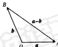
(2) 利用相反向量作图, 通过向量加法的平行四边形法则作出  $\vec{a}-\vec{b}$ . 作  $\vec{OA}=\vec{a}, \vec{OB}=\vec{b}, \vec{AC}=-\vec{b}$ , 则  $\vec{OC}=\vec{a}+(-\vec{b})$ , 如图. 由图可知, 一个向量减去另一个向量等于加上这个向量的相反向量.
